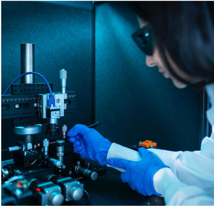
Prüfung der optischen „Kabel“: Vor dem Zusammenbau wird ermittelt, wie sich das Licht in den dünnen Leitern ausbreitet.
